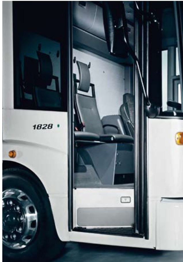
Sicher einsteigen: Die im Fahrerhaus integrierte und geschützte Einstiegsstufe sowie robuste Trittbeläge aus Kunststoff mit Kantenschutz sorgen für optimalen Halt.
