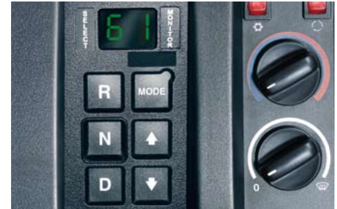
Entlastung pur: die Tastenschaltung des serienmäßigen 6-Gang-Automatik-Getriebes mit hydraulischem Wandler.
